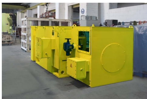
Bild: Menzel Elektromotoren hat für eine Zementmühle einen Schleifringläufermotor mit Kurzschluss- und Bürstenabhebevorrichtung (KBAV) konfiguriert
