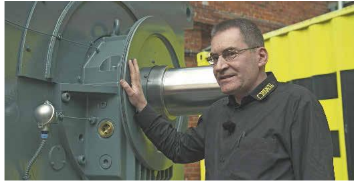
Martin Wagner, Projektleiter Hochspannungsantriebe bei Menzel, zeigt den mit minimalen Toleranzen maßgefertigten öl- und gasdichten Stützring für die Kupplungsverschalung
